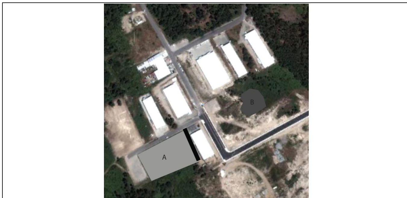
Figura 5.97: Condições de visibilidade (mancha cinzenta clara – A: área já escavada; mancha cinzenta escura – B: área de empréstimo de terras com visibilidade nula) e localização do corte Este (linha preta), descrito abaixo.
